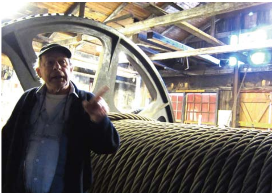
Åke Sjöberg vid den stora dragtrumman med en vajer som är nära decimetern tjock. Det behövdes när man skulle spela upp en 3000-tonnare ur vattnet.
